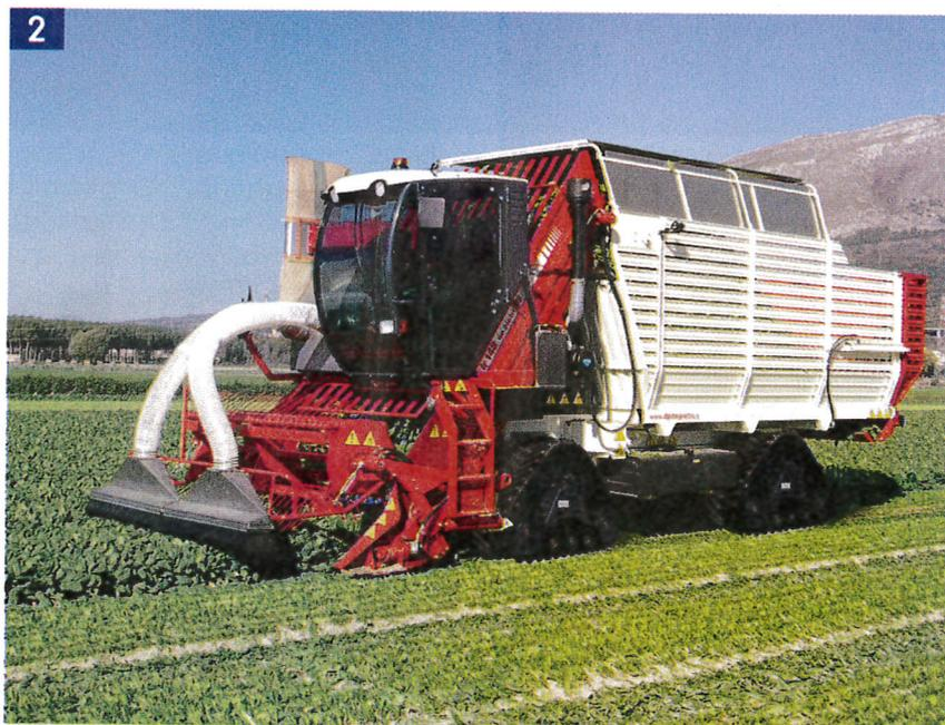
2) è la più grande falciaraccogliitrice dell'azienda reggiana. Questo modello è dotato di doppia lama di taglio che permette di avere un taglio netto e preciso senza danneggiare il prodotto raccolto. È equipaggiata con nuovo motore John Deere Stage V, 4 cilindri turbo con una potenza di 140 hp. La trasmissione idrostatica è Sauer Danfoss a quattro ruote motrici (disinseribili), coman-
