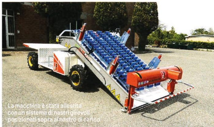
La macchina è stata allestita con un sistema di nastri girevoli posizionati sopra al nastro di carico
