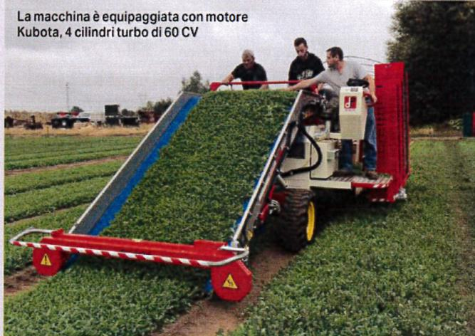
La macchina è equipaggiata con motore Kubota, 4 cilindri turbo di 60 CV
